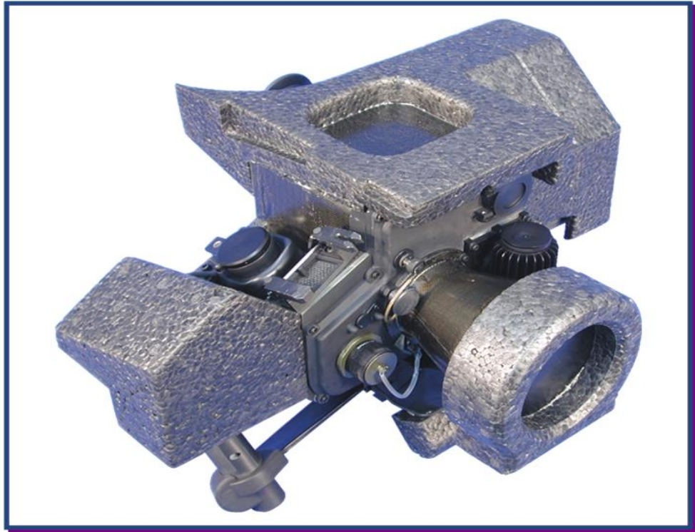
Рисунок 1.2 – командно-пусковий блок M98A2 (CLU) ПТРК “Javelin FGM-148”.
